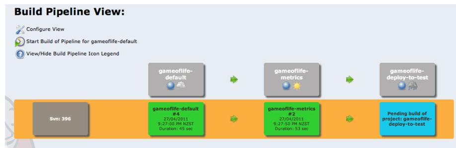
Figure 12.1. Une chaîne simple de déploiement automatisé
