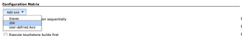
Figure 10.20. Ajouter un axe à un build multiconfiguration
